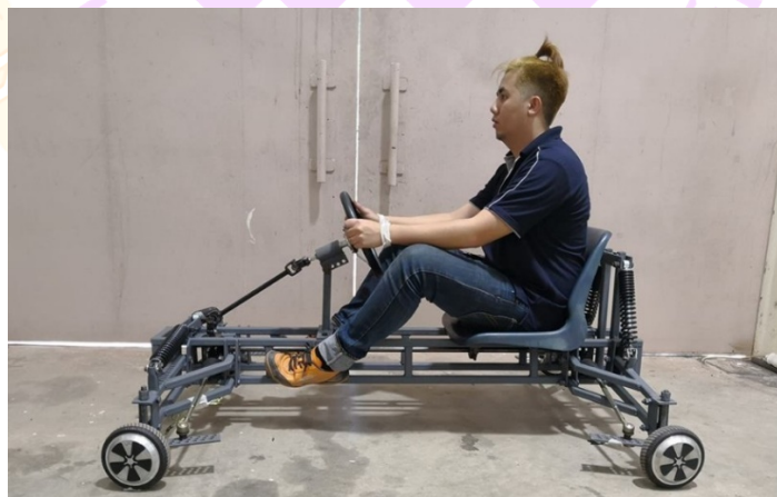
รูปที่ 4.11 รถไฟฟ้าขนาดเล็กที่ใช้มอเตอร์ดุมล้อ
